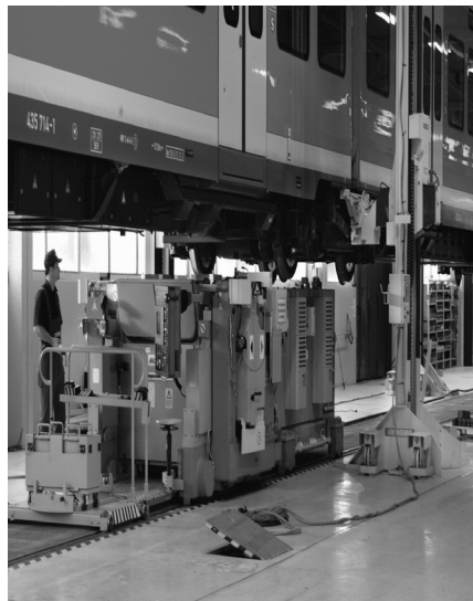
MOBITURN, die weltweit erste mobile Radsatz-Drehmaschine
